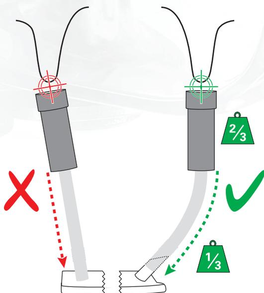
Die Ergebnisse: ein gerader Sitz der Melkbecher und eine optimale Bewegungsfreiheit des Melkzeugs. Die empfindlichen Zitzen werden gleichmäßig belastet und geschont. Die einzelnen Euterviertel werden optimal ausgemolken.
