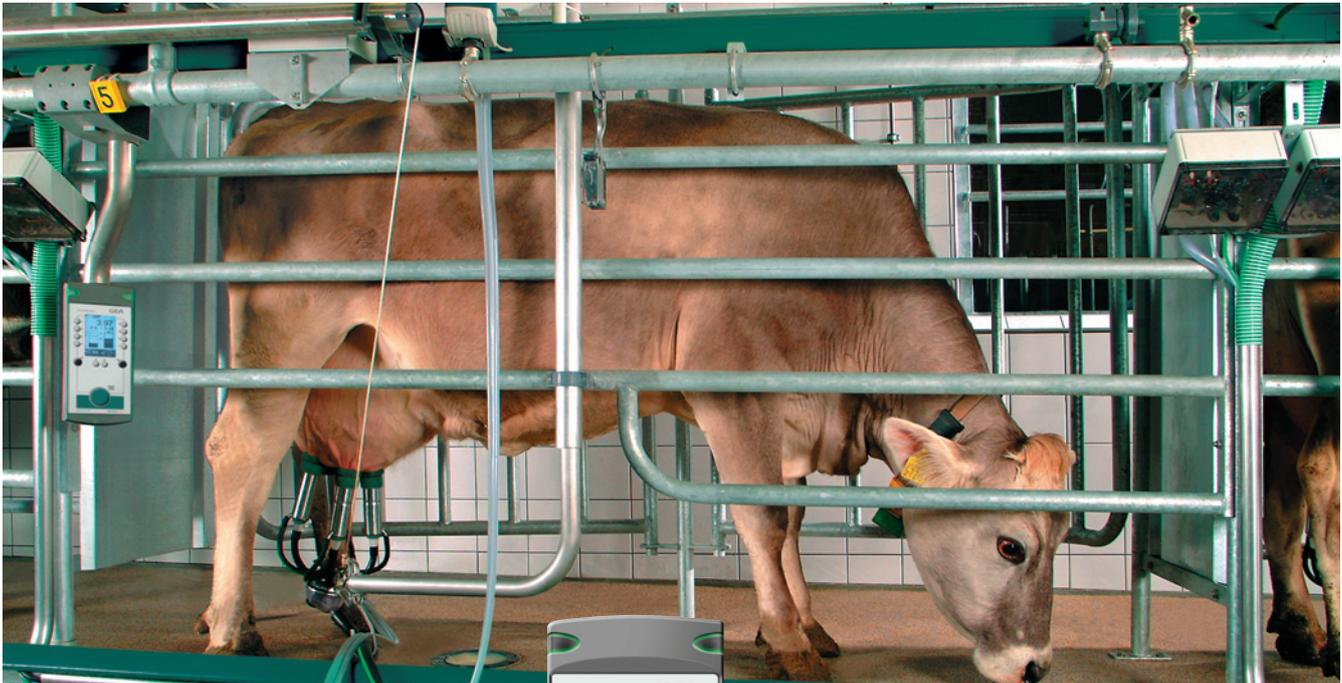
**Das variable Melkstandsystem.** Ohne Abstriche bei den melktechnischen Vorteilen lassen sich die Einzelboxen in den verschiedensten Grundrissen anordnen. Je nach Gebäude werden L-Formen, U-Formen oder einseitige Melkstände realisiert. Das macht das AutoTandem Konzept für alle Herdengrößen so interessant.
