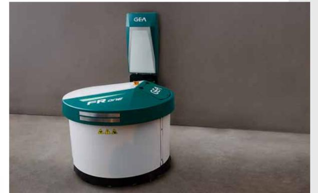
Der GEA FRone fährt die Ladestation selbstständig an und kann sie je nach Bedarf vorwärts oder rückwärts wieder verlassen.
