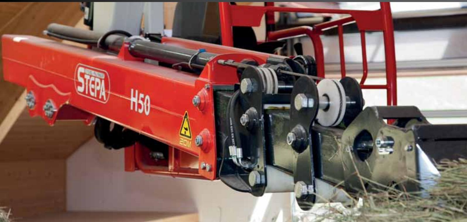
Auf Laufrollen gelagerte Ausschübe erreichen Dank der Gleichlaufsteuerung, über hochfeste Stahlseile und Umlenkrollen, hohe Aus- & Einfahrtgeschwindigkeiten. Das erhöht die Schlagkraft beim Abladen der Heuernte zu Spitzenzeiten.
