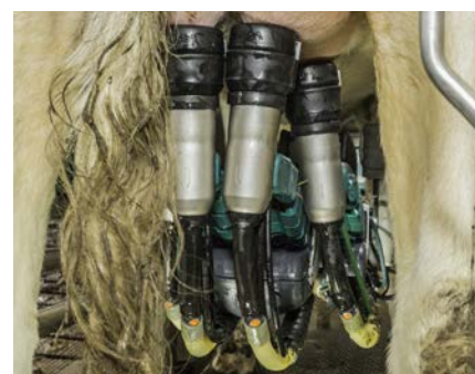
Die Melkbecher reinigen, stimulieren, melken und dippen die Zitzen. Während des viertelindividuellen Melkens bleibt der smarte Roboterarm unter dem Euter.
