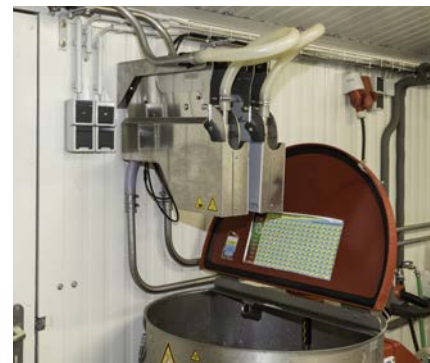
Die MS1 (Option) separiert und sammelt in einem bereitstehenden Tank die Milch für die Kälber.
