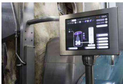
Nah bei: Das Industrie-Bedienterminal befindet sich in Euternähe. Alle relevanten Tierdaten und Robotereinstellungen können so am Tier eingesehen und verändert werden.
